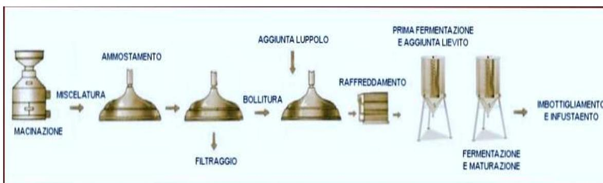
Figura 12. Ciclo produttivo della birra, schema tratto da [http://www.leonemastromarino.it/ciclo\\_produttivo.html](http://www.leonemastromarino.it/ciclo_produttivo.html).
